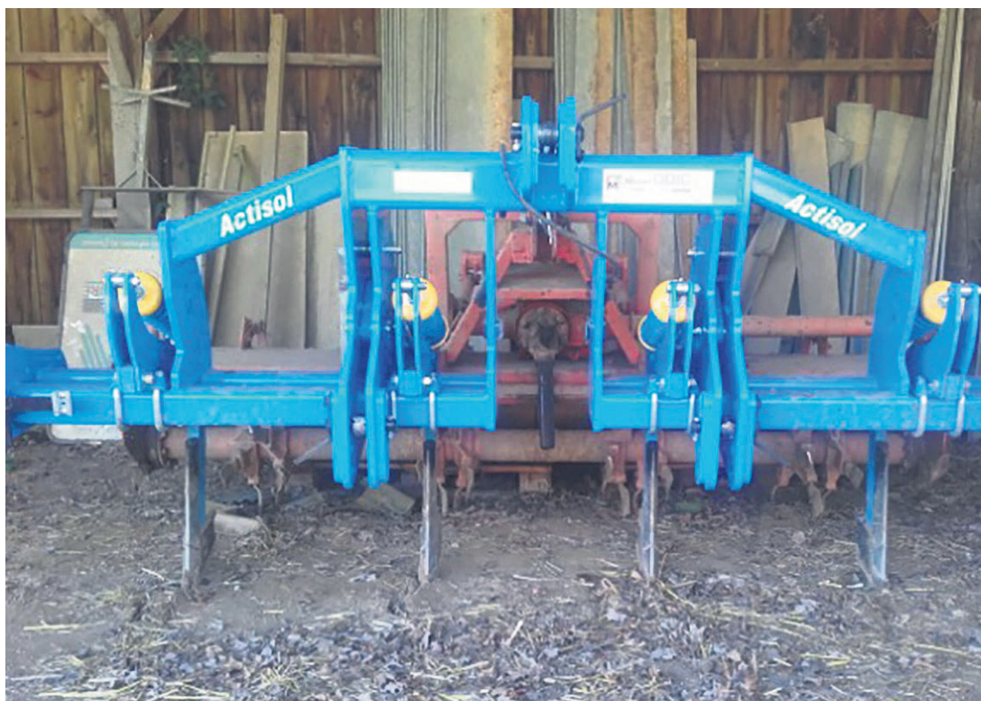
> L'actisol combiné au rotasemis. Les dents sont alignées avec les parties travaillantes de l'outil animé.
