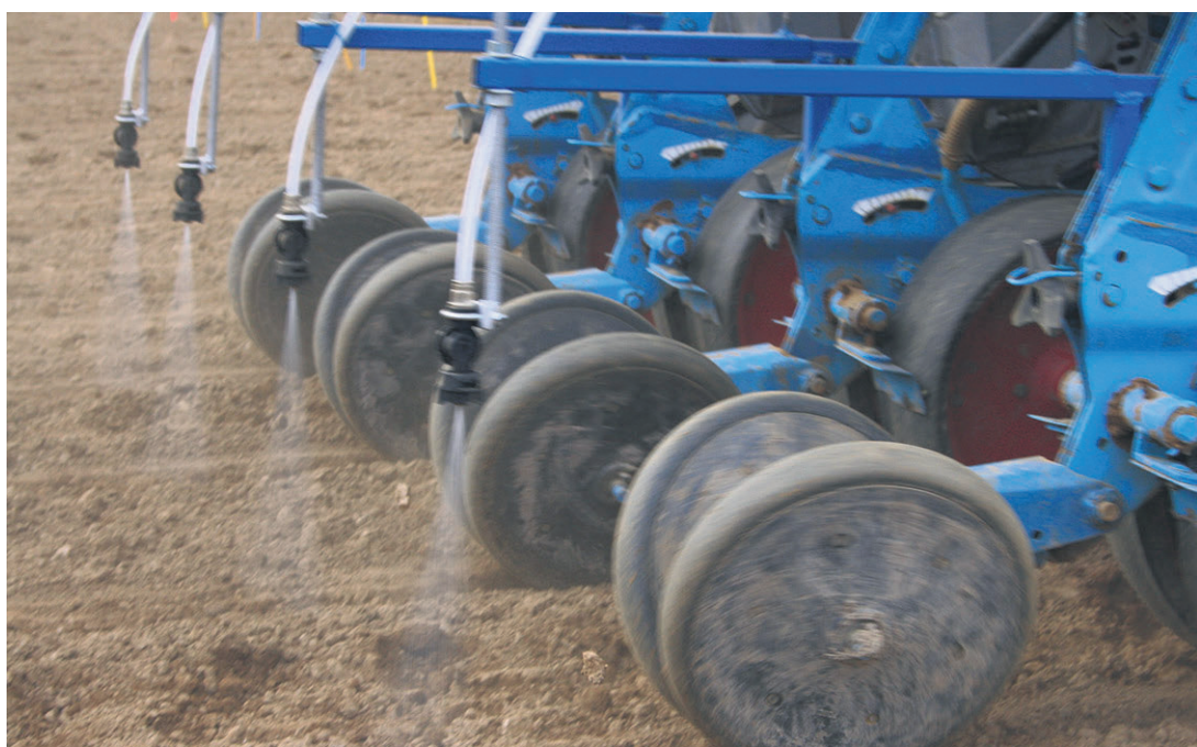
> Localisation sur le rang de l'herbicide de prélevé au moment du semis (33 % de la surface traitée).
